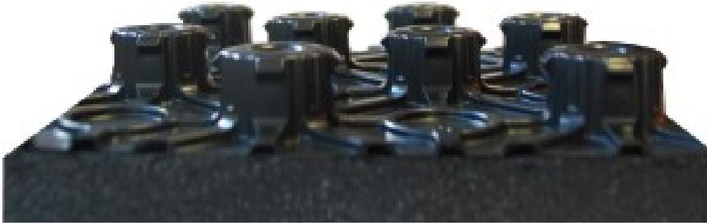
Il **MINIVARIANT 25 GRAFITE** è un esclusivo pannello bugnato ideato da EHT Italia, specifico per soddisfare gli obiettivi imposti dalle recenti normative in termini energetici. E' facile da installare e particolarmente adatto anche ai sistemi più moderni di generazione del calore. Ha una bugna di altezza 15 mm per alloggiare perfettamente il tubo  $\varnothing 12 \times 2$  mm, mentre l'isolante in EPS200 additivato con grafite è di spessore 10 mm.
