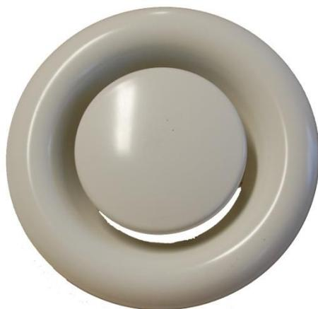
Valvola di ripresa DN150 per impianti di Ventilazione Meccanica Controllata utilizzata per il ricircolo, dotata di fungo centrale regolabile manualmente e realizzata in acciaio verniciato bianco. Studiata per l'installazione a controsoffitto.
