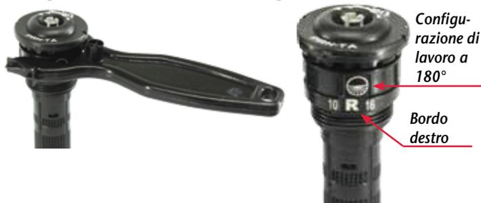
L'esclusivo metodo di regolazione consente la preimpostazione, manuale o con l'utensile, dell'arco di lavoro prima dell'installazione dell'ugello. Gli indicatori visivi consentono la rapida regolazione della configurazione dell'angolo di lavoro prescelto da 45 a 270°. La ghiera di regolazione è regolabile a mano o con l'utensile a corredo. L'utensile può essere ordinato a parte come: PRNTOOL
