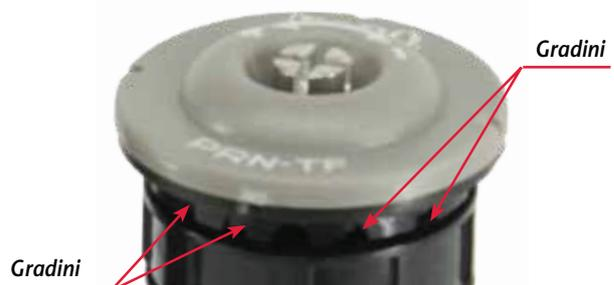
La tecnologia Step-Up™ garantisce una distribuzione idrica omogenea e proporzionale di elevata uniformità per l'irrigazione a distanza ravvicinata fino al punto più lontano della gittata. Gli speciali "gradini" creano 15 getti, ciascuno progettato per coprire un'area dell'angolo di lavoro.
